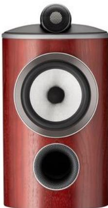
Diffusore da stand a 2 vie, bass reflex Flowport, 1 woofer/midrange da 165mm con membrana Continuum e cupola centrale antirisonanze, 1 tweeter da 25mm con cupola in diamante e alloggiamento allungato in alluminio pieno, montato in aria libera. Nuova struttura interna Matrix in legno multistrato. Predisposta per bi-wiring, potenza 50-120W su 8ohm.
