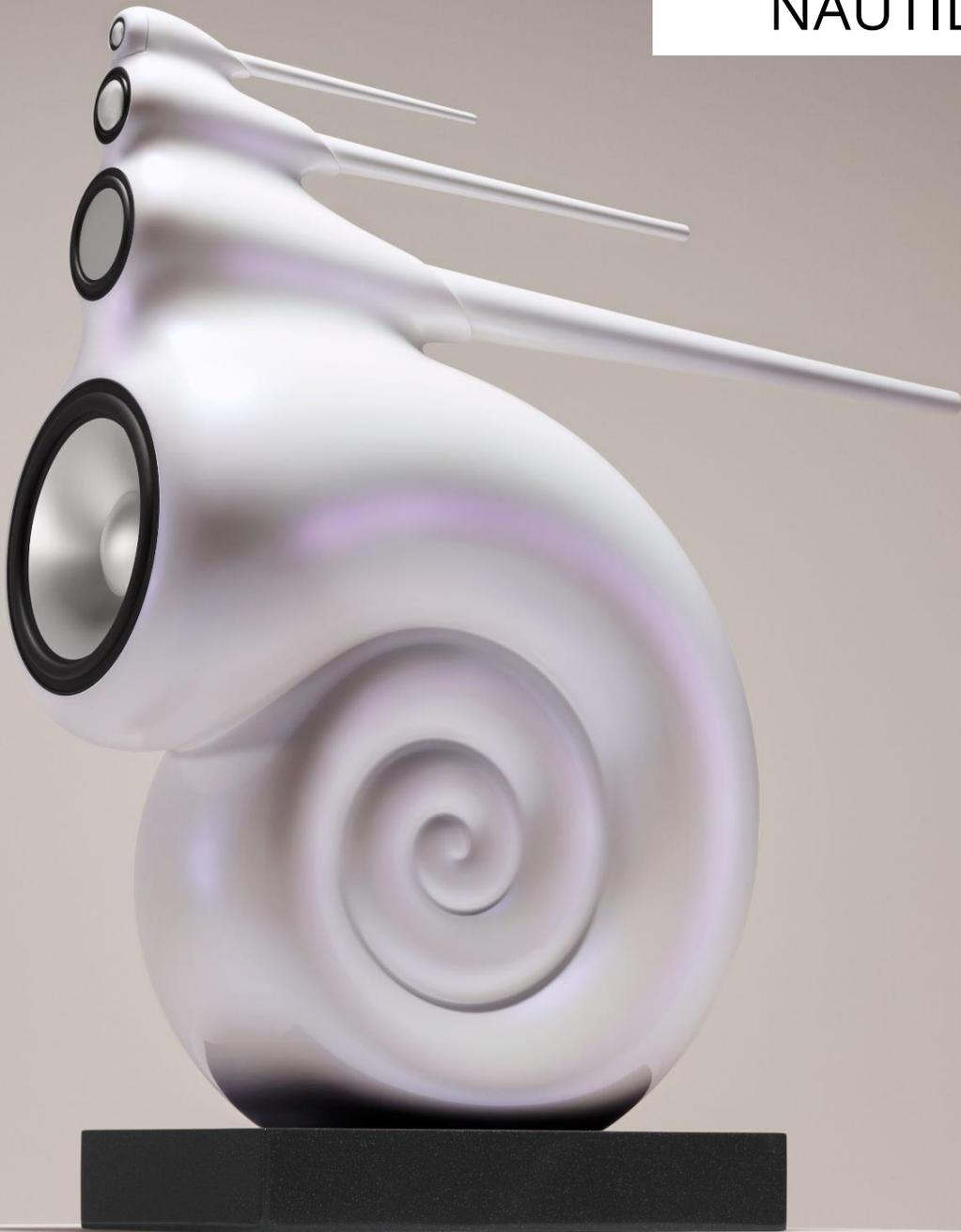
Il più iconico diffusore Bowers & Wilkins. Diffusore da pavimento a 4 vie, 4 altoparlanti, sistema con woofer in sospensione pneumatica e medi - medio alti - alti in transmission line. Crossover elettronici esterni in dotazione, da utilizzarsi esclusivamente in quadri-amplificazione. Interamente costruite a mano, finitura con verniciatura 'automotive' metallizzata.
