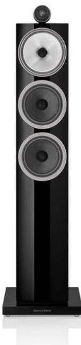
Diffusore da pavimento a 3 vie, bass reflex posteriore con tecnologia Flowport. Tweeter da 25mm con cupola in carbonio montato esternamente e disaccoppiato ('tweeter on-top'). Midrange FST disaccoppiato da 150mm con membrana in Continuum e sospensione biomimetica. 2 Woofer da 165mm con membrana in Aerofoil. 30-200W su 8 ohm. 90dB. Cabinet frontale curvato per migliorare la diffrazione.
