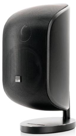
Mini diffusore a 2 vie in bass reflex, tweeter da 25mm con cupola metallica e caricamento Nautilus , bass/midrange da 100mm con cono in fibra di vetro e cono parapolvere con proprietà antirisonanti, altoparlanti con complesso magnetico schermato, piedistallo cromato integrato con snodo orientabile e passaggio interno dei cavi, potenza da 20 a 100 W.
