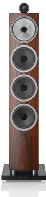
Diffusore da pavimento a 3 vie, bass reflex posteriore con tecnologia Flowport. Tweeter da 25mm con cupola in carbonio montato esternamente e disaccoppiato ('tweeter on-top'). Midrange FST disaccoppiato da 150mm con membrana in Continuum e sospensione biomimetica. 3 Woofer da 165mm con membrana in Aerofoil. 30-300W su 8 ohm. 90dB. Cabinet frontale curvato per migliorare la diffrazione.
