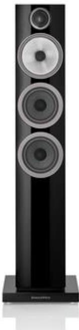
Diffusore da pavimento a 3 vie, bass reflex posteriore con tecnologia Flowport. Tweeter disaccoppiato da 25mm con cupola in carbonio. Midrange FST disaccoppiato da 130mm con membrana in Continuum e sospensione biomimetica. 2 Woofer da 130mm con membrana in Aerofoil. 30-150W su 8 ohm. 88dB. Cabinet frontale curvato per migliorare la diffrazione.
