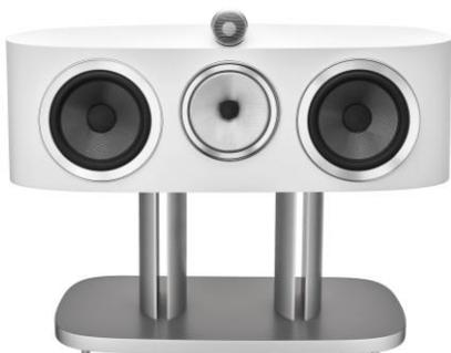
Diffusore centrale a 3 vie, bass reflex Flowport,, 2 woofer da 200mm con membrana Aerofoil, 1 midrange FST da 150mm con membrana Continuum e sospensione biomimetica inserito nella nuova testa a turbina realizzata in singolo blocco di alluminio, 1 tweeter da 25mm con cupola in diamante e alloggiamento allungato in alluminio pieno, montato in aria libera. Nuova struttura interna Matrix ottimizzata. Predisposta per bi-wiring, potenza 50-500W, 8ohm. Mobile in legno a struttura inversa.
