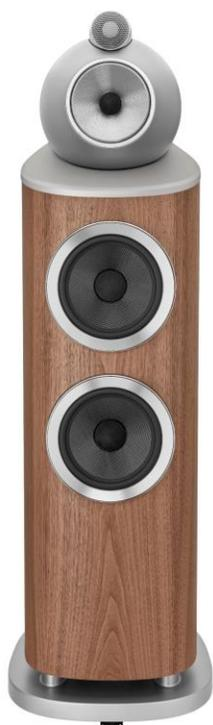
Diffusore da pavimento a 3 vie, bass reflex con tecnologia Flowport, 2 woofer da 180mm con membrana Aerofoil, 1 midrange FST da 130mm con membrana Continuum e sospensione biomimetica inserito nella nuova testa a turbina realizzata in singolo blocco di alluminio, 1 tweeter da 25mm con cupola in diamante e alloggiamento allungato in alluminio pieno, montato in aria libera. Nuova struttura interna Matrix in legno multistrato e metallo. Predisposta per bi-wiring, potenza 50-500W su 8ohm.
