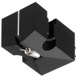
Testina Moving Coil (MC) superiore con tensione di uscita 0.3 mV, risposta in frequenza 20Hz - 45KHz, impedenza di uscita 40 Ohm, peso 8.5g.
